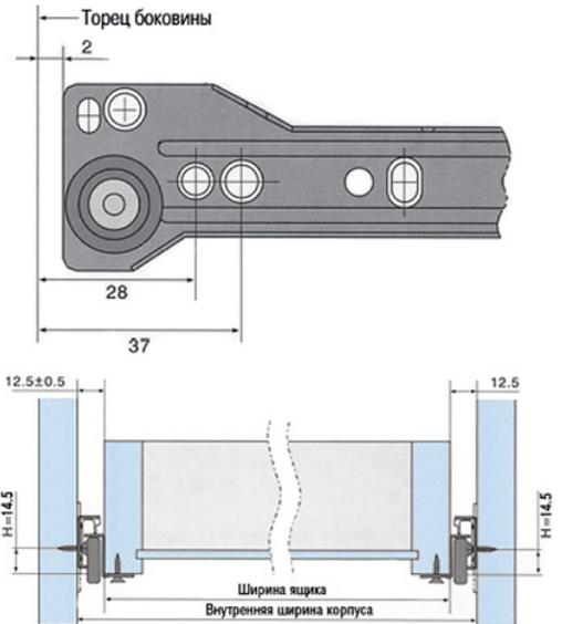
При изготовлении вкладных ящиков к присадочным размерам следует добавлять толщину фасадов + 2 мм.
