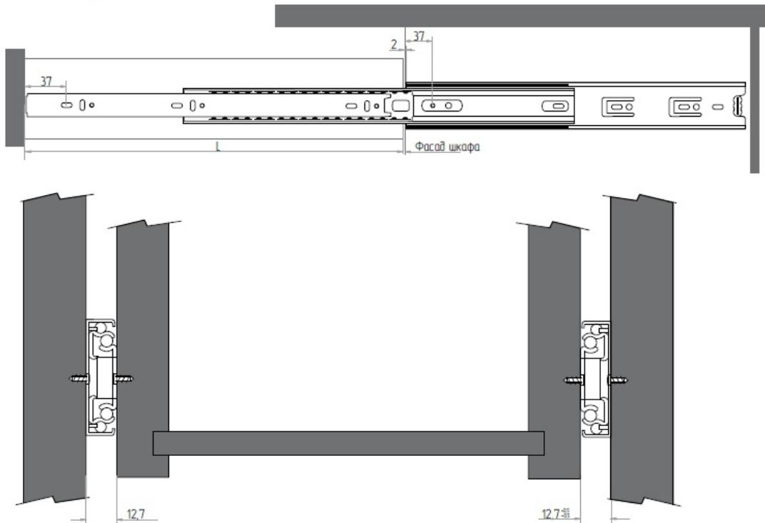
При изготовлении вкладных ящиков к присадочным размерам следует добавлять толщину фасадов + 2 мм.
