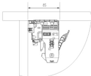
При изготовлении вкладных ящиков к присадочным размерам следует добавлять толщину фасадов + 2 мм.
